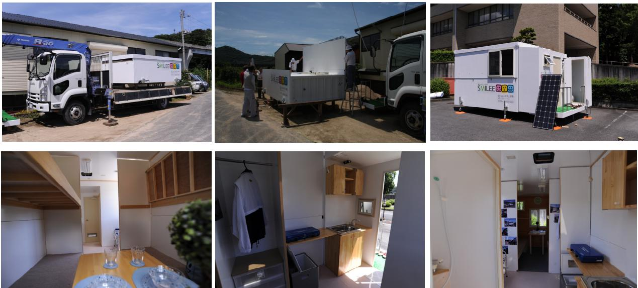
1型に比べ一回り大きく、トイレは外付けとし、フリースペースを設けるなど居住性を向上させ、組立て方式を改善した。4t トラックに2戸、10t トラックに6戸積載可能。
