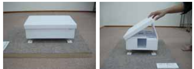
(a)折畳んだ状態:右側面より撮影 (屋根部分が弁当の蓋のようになっている) (b)屋根の右側を持ち上げ、内側に折り畳んだ右側面の壁を起し屋根部分の右隅に固定する
