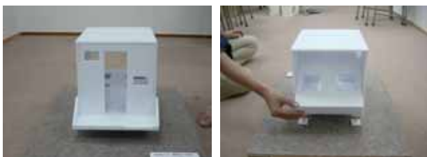
(e)前面の壁を垂直に起こした状態 (前面の壁で、側面の壁は固定される) (f)後面の壁(ボックス状)を人力で起こす (奥行きは60cm拡張する)
