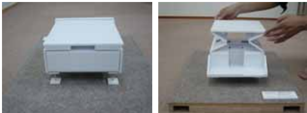
(a)折畳んだ状態:後方より撮影 (側面上部壁は、2枚の部材により内側に折り畳まれている) (b)天井部分をクレーンで少し持ち上げた状態 (片側ずつ持ち上げてよい)
