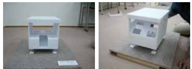
(c)両側面の壁を起こした状態 (屋根の左側を持ち上げ、左側面の壁を起こす) (d)後方の壁をを起こし始めた状態 (モデルAのように、後壁を箱型にすることも可能)
