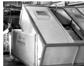
(b) 入口の吹き出し部分の組立
